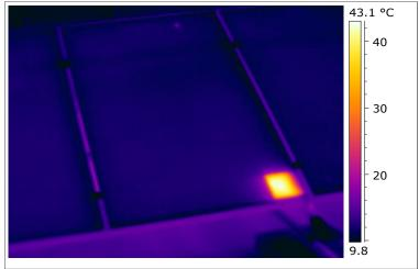
Sur ce panneau le défaut est déjà plus prononcé. On constate, sur la photo, le noircissement de la zone concernée. Le remplacement du panneau s'impose, pour éviter tout risque de sinistre et de dégradation d'autres panneaux, sur le même circuit.
